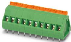
Leiterplattenklemme, Nennstrom: 16 A, Bemessungsspannung (III/2): 400 V, Nennquerschnitt: 1,5 mm<sup>2</sup>, Anzahl der Potenziale: 13, Anzahl der Reihen: 1, Polzahl pro Reihe: 13, Artikelfamilie: ZFKDS(A) 1,5-W, Rastermaß: 5,08 mm, Anschlussart: Zugfederanschluss, Montage: Wellenlöten, Anschlussrichtung Leiter/Platine: 45 °, Farbe: grün, Pin-Layout: Lineares Pinning, Pinlänge [P]: 3,5 mm, Anzahl der Lötpins pro Potenzial: 2, Verpackungsart: verpackt im Karton
