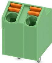
Leiterplattenklemme, Nennstrom: 9 A, Bemessungsspannung (III/2): 320 V, Nennquerschnitt: 1 mm<sup>2</sup>, Anzahl der Potentiale: 2, Anzahl der Reihen: 1, Polzahl pro Reihe: 2, Artikelfamilie: SPTA 1/, Rastermaß: 5 mm, Anschlussart: Push-in-Federanschluss, Montage: Wellenlöten, Anschlussrichtung Leiter/Platine: 65 °, Farbe: grün, Pin-Layout: Lineares Pinning, Pinlänge [P]: 3,5 mm, Anzahl der Lötpins pro Potenzial: 1, Verpackungsart: verpackt im Karton
