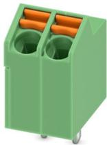
Leiterplattenklemme, Nennstrom: 9 A, Bemessungsspannung (III/2): 200 V, Nennquerschnitt: 1 mm<sup>2</sup>, Anzahl der Potentiale: 2, Anzahl der Reihen: 1, Polzahl pro Reihe: 2, Artikelfamilie: SPTA 1/, Rastermaß: 3,5 mm, Anschlussart: Push-in-Federanschluss, Montage: Wellenlöten, Anschlussrichtung Leiter/Platine: 65 °, Farbe: grün, Pin-Layout: Lineares Pinning, Pinlänge [P]: 3,5 mm, Anzahl der Lötpins pro Potenzial: 1, Verpackungsart: verpackt im Karton
