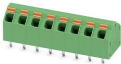
Leiterplattenklemme, Nennstrom: 17,5 A, Bemessungsspannung (III/2): 320 V, Nennquerschnitt: 1,5 mm<sup>2</sup>, Anzahl der Potenziale: 8, Anzahl der Reihen: 1, Polzahl pro Reihe: 8, Artikelfamilie: SPTA 1,5/, Rastermaß: 5,08 mm, Anschlussart: Push-in-Federanschluss, Montage: Wellenlöten, Anschlussrichtung Leiter/Platine: 45 °, Farbe: grün, Pin-Layout: Lineares Pinning, Pinlänge [P]: 3,4 mm, Anzahl der Lötpins pro Potenzial: 2, Verpackungsart: verpackt im Karton
