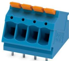
Leiterplattenklemme, Nennstrom: 24 A, Bemessungsspannung (III/2): 400 V, Nennquerschnitt: 2,5 mm<sup>2</sup>, Anzahl der Reihen: 1, Polzahl pro Reihe: 4, Artikelfamilie: LPTA 2,5/, Rastermaß: 5 mm, Anschlussart: Hebel-Push-in-Anschluss, Montage: Wellenlöten, Anschlussrichtung Leiter/Platine: 30 °, Farbe: blau, Pin-Layout: Lineares Pinning, Pinlänge [P]: 3,5 mm, Verpackungsart: verpackt im Karton
