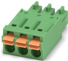
Leiterplattenstecker, Nennquerschnitt: 1,5 mm<sup>2</sup>, Farbe: grün, Nennstrom: 8 A, Bemessungsspannung (III/2): 160 V, Kontaktoberfläche: Sn, Kontaktart: Buchse, Anzahl der Potenziale: 3, Anzahl der Reihen: 1, Polzahl: 3, Anzahl der Anschlüsse: 3, Artikelfamilie: FMC 1,5/..-ST, Rastermaß: 3,81 mm, Anschlussart: Push-in-Federanschluss, Anschlussrichtung Leiter/Platine: 0 °, Stecksystem: COMBICON FMC 1,5 - MCDN 1,5, Verriegelung: ohne, Befestigungsart: ohne, Verpackungsart: verpackt im Karton
