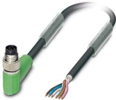
Sensor-/Aktor-Kabel, 6-polig, PUR halogenfrei, schwarzgrau RAL 7021, Stecker gewinkelt M8, Kodierung: A, auf freies Leitungsende, Kabellänge: 0,5 m, Kundenvariante, Kodierung 315°
