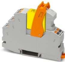
Vormontiertes Relaismodul mit Push-in-Anschluss, bestehend aus: Relaissockel, Sicherheitsrelais mit zwangsgeführten Kontakten gemäß DIN EN 61810-3, steckbarem Anzeige-/Entstörmodul und Haltebügel, Kontaktausführung: 2 Wechsler, Mehrlagen-Goldkontakt, Eingangsspannung: 24 V DC
