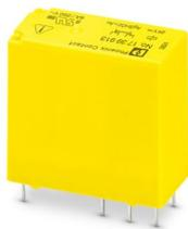
Sicherheitsrelais mit zwangsgeführten Kontakten gemäß DIN EN 61810-3, Kontaktausführung: 2 Wechsler, Mehrlagen-Goldkontakt. Die Anforderungen für Typ A gemäß DIN EN 61810-3 werden erfüllt, wenn die Beschaltung als 1 Schließer/1 Öffner erfolgt.
