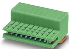
Leiterplatten-Direktstecker, Nennquerschnitt: 1 mm<sup>2</sup>, Farbe: grün, Nennstrom: 8 A, Bemessungsspannung (III/2): 200 V, Kontaktoberfläche: Sn, Kontaktart: Buchse, Anzahl der Reihen: 1, Polzahl: 4, Artikelfamilie: ZEC 1,0/..-ST, Rastermaß: 3,5 mm, Anschlussart: Zugfederanschluss, Montage: Direktstecktechnik, Anschlussrichtung Leiter/Platine: 0 °, Stecksystem: ZEC, Verriegelung: Rastverriegelung, Befestigungsart: Rastflansch, Verpackungsart: verpackt im Karton
