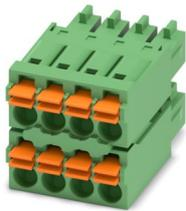
Leiterplattenstecker, Nennquerschnitt: 1,5 mm<sup>2</sup>, Farbe: grün, Nennstrom: 8 A, Bemessungsspannung (III/2): 160 V, Kontaktoberfläche: Sn, Kontaktart: Buchse, Anzahl der Potenziale: 8, Anzahl der Reihen: 2, Polzahl: 4, Anzahl der Anschlüsse: 8, Artikelfamilie: FMCD 1,5/..-ST, Rastermaß: 3,5 mm, Anschlussart: Push-in-Federanschluss, Anschlussrichtung Leiter/Platine: 0 °, Stecksystem: COMBICON FMC 1,5 - MCDN 1,5, Verriegelung: ohne, Befestigungsart: ohne, Verpackungsart: verpackt im Karton
