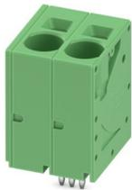
Leiterplattenklemme, Nennstrom: 76 A, Bemessungsspannung (III/2): 1000 V, Nennquerschnitt: 16 mm<sup>2</sup>, Anzahl der Potenziale: 2, Anzahl der Reihen: 1, Polzahl pro Reihe: 2, Artikelfamilie: SPT 16/..-V, Rastermaß: 10 mm, Anschlussart: Push-in-Federanschluss, Montage: Wellenlöten, Anschlussrichtung Leiter/Platine: 90 °, Farbe: grün, Pin-Layout: Zick-Zack-Pinning W, Pinlänge [P]: 4,1 mm, Anzahl der Lötpins pro Potenzial: 3, Verpackungsart: verpackt im Karton
