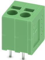
Leiterplattenklemme, Nennstrom: 22 A, Nennquerschnitt: 2,5 mm<sup>2</sup>, Anzahl der Potenziale: 2, Anzahl der Reihen: 1, Polzahl pro Reihe: 2, Artikelfamilie: SPT 2,5/..-V-EX, Rastermaß: 5 mm, Anschlussart: Push-in-Federanschluss, Montage: Wellenlöten, Anschlussrichtung Leiter/Platine: 90 °, Farbe: grün, Pin-Layout: Lineares Pinning, Pinlänge [P]: 2,5 mm, Anzahl der Lötpins pro Potenzial: 2, Verpackungsart: verpackt im Karton
