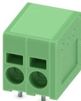
Leiterplattenklemme, Nennstrom: 23 A, Nennquerschnitt: 2,5 mm<sup>2</sup>, Anzahl der Potenziale: 2, Anzahl der Reihen: 1, Polzahl pro Reihe: 2, Artikelfamilie: SPT 2,5/..-H-EX, Rastermaß: 5 mm, Anschlussart: Push-in-Federanschluss, Montage: Wellenlöten, Anschlussrichtung Leiter/Platine: 0 °, Farbe: grün, Pin-Layout: Lineares Pinning, Pinlänge [P]: 2,5 mm, Anzahl der Lötpins pro Potenzial: 2, Verpackungsart: verpackt im Karton
