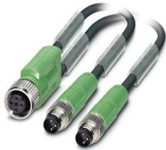
Sensor-/Aktor-Kabel, 3-polig, PUR halogenfrei, schwarzgrau RAL 7021, Buchse gerade M12, auf Stecker gerade M8 und Stecker gerade M8, Kabellänge: 0,5 m
