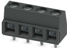
Leiterplattenklemme, Nennstrom: 17,5 A, Bemessungsspannung (III/2): 400 V, Nennquerschnitt: 1,5 mm<sup>2</sup>, Anzahl der Reihen: 1, Polzahl pro Reihe: 4, Artikelfamilie: MKDSN 1,5, Rastermaß: 5 mm, Anschlussart: Schraubanschluss mit Zughülse, Schraubenangriffsform: L Längsschlitz, Montage: Wellenlöten, Anschlussrichtung Leiter/Platine: 0 °, Farbe: schwarz, Pin-Layout: Lineares Pinning, Pinlänge [P]: 3,5 mm, Anzahl der Lötpins pro Potenzial: 1, Verpackungsart: verpackt im Karton
