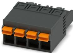
Leiterplattenstecker, Nennquerschnitt: 2,5 mm<sup>2</sup>, Farbe: schwarz, Nennstrom: 12 A, Bemessungsspannung (III/2): 320 V, Kontaktoberfläche: Sn, Kontaktart: Buchse, Anzahl der Reihen: 1, Polzahl: 4, Artikelfamilie: FKCN 2,5/..-ST, Rastermaß: 5 mm, Anschlussart: Push-in-Federanschluss, Anschlussrichtung Leiter/Platine: 0 °, Rasthaken: - Rasthaken, Stecksystem: COMBICON MSTB 2,5, Verriegelung: ohne, Befestigungsart: ohne, Verpackungsart: verpackt im Karton
