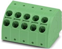
Leiterplattenstecker, Nennquerschnitt: 2,5 mm<sup>2</sup>, Farbe: grün, Nennstrom: 13,5 A, Bemessungsspannung (III/2): 400 V, Kontaktoberfläche: Sn, Kontaktart: Buchse, Anzahl der Potenziale: 5, Anzahl der Reihen: 1, Polzahl: 5, Anzahl der Anschlüsse: 10, Artikelfamilie: PTDA 2,5/..-PH, Rastermaß: 5 mm, Anschlussart: Push-in-Federanschluss, Anschlussrichtung Leiter/Platine: 45 °, Stecksystem: COMBICON PST 1,3, Verriegelung: ohne, Befestigungsart: ohne, Verpackungsart: verpackt im Karton
