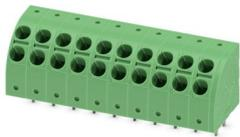
Leiterplattenklemme, Nennstrom: 24 A, Bemessungsspannung (III/2): 400 V, Nennquerschnitt: 2,5 mm<sup>2</sup>, Anzahl der Potenziale: 10, Anzahl der Reihen: 1, Polzahl pro Reihe: 10, Artikelfamilie: PTDA 2,5/, Rastermaß: 5 mm, Anschlussart: Push-in-Federanschluss, Montage: Wellenlöten, Anschlussrichtung Leiter/Platine: 45 °, Farbe: grün, Pin-Layout: Lineares Pinning, Pinlänge [P]: 3,5 mm, Anzahl der Lötpins pro Potenzial: 2, Verpackungsart: verpackt im Karton
