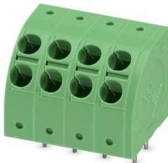
Leiterplattenklemme, Nennstrom: 24 A, Bemessungsspannung (III/2): 400 V, Nennquerschnitt: 2,5 mm<sup>2</sup>, Anzahl der Potenziale: 4, Anzahl der Reihen: 1, Polzahl pro Reihe: 4, Artikelfamilie: PTDA 2,5/, Rastermaß: 5 mm, Anschlussart: Push-in-Federanschluss, Montage: Wellenlöten, Anschlussrichtung Leiter/Platine: 45 °, Farbe: grün, Pin-Layout: Lineares Pinning, Pinlänge [P]: 3,5 mm, Anzahl der Lötpins pro Potenzial: 2, Verpackungsart: verpackt im Karton
