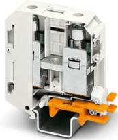
Hochstromklemme, Nennspannung: 1000 V, Nennstrom: 192 A, Anzahl der Anschlüsse: 2, Polzahl: 1, Anschlussart: Schraubanschluss, Bemessungsquerschnitt: 70 mm<sup>2</sup>, Querschnitt: 16 mm<sup>2</sup> - 95 mm<sup>2</sup>, Montageart: NS 35/7,5, NS 35/15, NS 35/15-2,3, NS 32, Farbe: weiß
