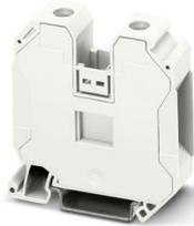
Durchgangsklemme, Nennspannung: 1000 V, Nennstrom: 125 A, Anzahl der Anschlüsse: 2, Anschlussart: Schraubanschluss, Bemessungsquerschnitt: 35 mm<sup>2</sup>, Querschnitt: 1,5 mm<sup>2</sup> - 50 mm<sup>2</sup>, Montageart: NS 35/7,5, NS 35/15, Farbe: weiß
