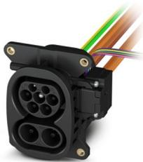
CHARX connect universal, AC/DC CCS Typ 2, Fahrzeug-Ladedose, > 500 A im Boost Mode, 325 A dauerhaft, 1000 V DC, 32 A, 480 V AC, Einzeladern, Länge: 2 m, Verriegelungsaktuator: 24 V, 4-polig, Vorder- und Rückwandmontage, M6, Gehäuse: schwarz, zum Laden mit Wechselstrom (AC) und mit Gleichstrom (DC), IEC 62196-1, IEC 62196-2, Für die DC- und AC-Kontakte ist eine Schutzkappe im Lieferumfang enthalten.
