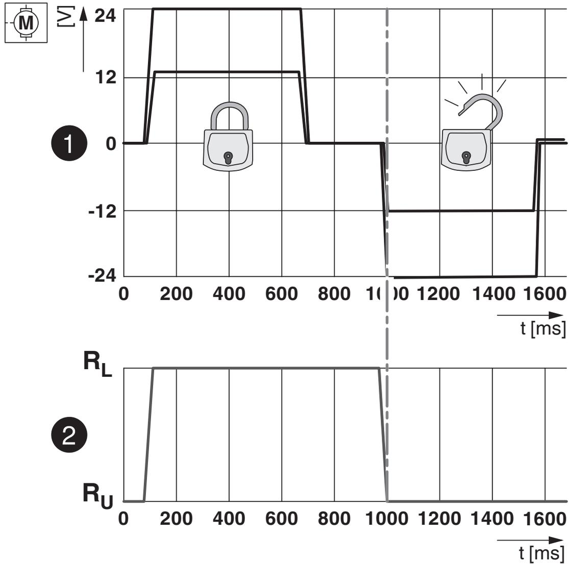
Verriegelungszustände des Verriegelungsaktuators
