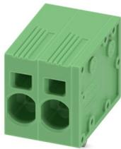
Leiterplattenklemme, Nennstrom: 41 A, Bemessungsspannung (III/2): 1000 V, Nennquerschnitt: 6 mm<sup>2</sup>, Anzahl der Potenziale: 2, Anzahl der Reihen: 1, Polzahl pro Reihe: 2, Artikelfamilie: SPT 5/...-H, Rastermaß: 7,5 mm, Anschlussart: Push-in-Federanschluss, Montage: Wellenlöten, Anschlussrichtung Leiter/Platine: 0 °, Farbe: grün, Pin-Layout: Zick-Zack-Pinning W, Pinlänge [P]: 4,6 mm, Anzahl der Lötpins pro Potenzial: 2, Verpackungsart: verpackt im Karton
