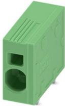
Leiterplattenklemme, Nennstrom: 41 A, Bemessungsspannung (III/2): 630 V, Nennquerschnitt: 6 mm<sup>2</sup>, Anzahl der Potenziale: 1, Anzahl der Reihen: 1, Polzahl pro Reihe: 1, Artikelfamilie: SPT 5/...-H, Rastermaß: 7,5 mm, Anschlussart: Push-in-Federanschluss, Montage: Wellenlöten, Anschlussrichtung Leiter/Platine: 0 °, Farbe: grün, Pin-Layout: Lineares Pinning, Pinlänge [P]: 4,6 mm, Anzahl der Löt pins pro Potenzial: 2, Verpackungsart: verpackt im Karton
