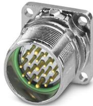
M23, Gerätesteckverbinder Vorderwand, Serie: M23 PRO Signal, gerade, geschirmt: ja, für Standard- und ONECLICK-Schnellverriegelung, Polzahl: 16+3, Drehsinn: Standard, Kontaktart: Stift, Crimpanschluss, Flanschmaß: 26 mm x 26 mm, Kodierung: N, Artikel ist bleifrei nach RoHS II ohne Ausnahme 6c (Pb < 0,1 %)
