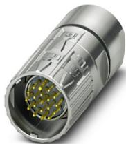
M23, Kabelsteckverbinder, Serie: M23 PRO, gerade, geschirmt: ja, ONECLICK-Schnellverriegelung, Polzahl: 16+3, Drehsinn: Standard, Kontaktart: Stift, Crimpanschluss, Kabeldurchmesserbereich: 9 mm ... 15 mm, Kodierung: N, Artikel ist bleifrei nach RoHS II ohne Ausnahme 6c (Pb < 0,1 %)
