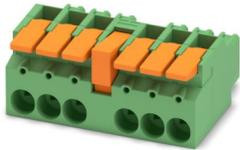
Leiterplattenstecker, Nennquerschnitt: 16 mm<sup>2</sup>, Farbe: grün, Nennstrom: 76 A, Bemessungsspannung (III/2): 1000 V, Kontaktoberfläche: Sn, Kontaktart: Buchse, Anzahl der Reihen: 1, Polzahl: 6, Artikelfamilie: LPC 16 HC/..-STL, Rastermaß: 10,16 mm, Anschlussart: Hebel-Push-in-Anschluss, Anschlussrichtung Leiter/Platine: 0 °, Rasthaken: - ohne Rasthaken, Stecksystem: POWER COMBICON 16 advanced, Verriegelung: Rastverriegelung, Befestigungsart: Rastflansch, Verpackungsart: verpackt im Karton
