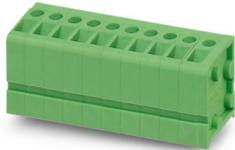
Leiterplattenklemme, Nennstrom: 24 A, Bemessungsspannung (III/2): 400 V, Nennquerschnitt: 2,5 mm<sup>2</sup>, Anzahl der Reihen: 1, Polzahl pro Reihe: 2, Artikelfamilie: FRONT 2,5-V/SA 5, Rastermaß: 5 mm, Anschlussart: Frontschraubanschluss, Montage: Wellenlöten, Anschlussrichtung Leiter/Platine: 90 °, Farbe: grün, Pin-Layout: Lineares Pinning, Pinlänge [P]: 3,5 mm, Anzahl der Lötpins pro Potenzial: 2, Verpackungsart: verpackt im Karton
