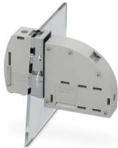
Durchführungsklemme, Anschlussart: Schraubanschluss mit Zughülse, Schraubanschluss mit Zughülse, Polzahl: 1, Belastungsstrom: 232 A, Anschlussrichtung des Leiters zur Steckrichtung: -90 °, Breite: 25 mm, Farbe: grau. Äußere Klemmhälfte mit Schraubflansch
