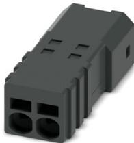
Leiterplattenstecker, Nennquerschnitt: 0,5 mm<sup>2</sup>, Farbe: schwarz, Nennstrom: 6 A, Bemessungsspannung (III/2): 160 V, Kontaktoberfläche: Sn, Kontaktart: Stift, Anzahl der Potenziale: 2, Anzahl der Reihen: 1, Polzahl: 2, Anzahl der Anschlüsse: 2, Artikelfamilie: PTSM 0,5/..-PI, Rastermaß: 2,5 mm, Anschlussart: Push-in-Federanschluss, Anschlussrichtung Leiter/Platine: 0 °, Stecksystem: COMBICON PTSM, Verriegelung: ohne, Befestigungsart: ohne, Verpackungsart: verpackt im Karton
