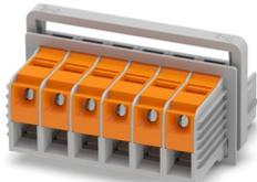
Durchführungsklemme, Anschlussart: T-LOX-Kniehebelanschluss, Kabelschuhanschluss, Polzahl: 6, Belastungsstrom: 150 A, Querschnitt: 10 mm<sup>2</sup> - 50 mm<sup>2</sup>, Anschlussrichtung des Leiters zur Steckrichtung: 0 °, Breite: 138 mm, Farbe: grau
