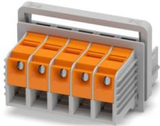
Durchführungsklemme, Anschlussart: T-LOX-Kniehebelanschluss, Kabelschuhanschluss, Polzahl: 5, Belastungsstrom: 150 A, Querschnitt: 10 mm<sup>2</sup> - 50 mm<sup>2</sup>, Anschlussrichtung des Leiters zur Steckrichtung: 0 °, Breite: 118 mm, Farbe: grau
