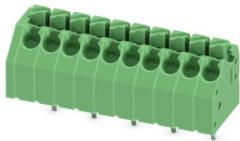
Leiterplattenklemme, Nennstrom: 8 A, Bemessungsspannung (III/2): 400 V, Nennquerschnitt: 1,5 mm<sup>2</sup>, Anzahl der Potenziale: 9, Anzahl der Reihen: 1, Polzahl pro Reihe: 9, Artikelfamilie: PTSA 1,5, Rastermaß: 3,5 mm, Anschlussart: Push-in-Federanschluss, Montage: Wellenlöten, Anschlussrichtung Leiter/Platine: 45 °, Farbe: mehrfarbig, Pin-Layout: Zick-Zack-Pinning M, Pinlänge [P]: 3,5 mm, Anzahl der Lötpins pro Potenzial: 1, Verpackungsart: verpackt im Karton
