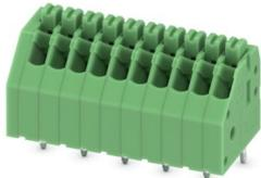
Leiterplattenklemme, Nennstrom: 2 A, Bemessungsspannung (III/2): 250 V, Nennquerschnitt: 0,5 mm<sup>2</sup>, Anzahl der Potenziale: 10, Anzahl der Reihen: 1, Polzahl pro Reihe: 10, Artikelfamilie: PTSA 0,5, Rastermaß: 2,5 mm, Anschlussart: Push-in-Federanschluss, Montage: Wellenlöten, Anschlussrichtung Leiter/Platine: 45 °, Farbe: grün, Pin-Layout: Zick-Zack-Pinning M, Pinlänge [P]: 3,6 mm, Anzahl der Lötpins pro Potenzial: 1, Verpackungsart: verpackt im Karton
