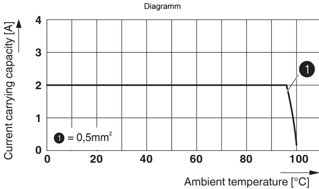
Derating-Diagramm für 5 Pole; Reduktionsfaktor=1
