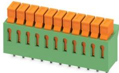
Leiterplattenklemme, Nennstrom: 5 A, Bemessungsspannung (III/2): 160 V, Nennquerschnitt: 0,34 mm<sup>2</sup>, Anzahl der Potenziale: 11, Anzahl der Reihen: 1, Polzahl pro Reihe: 11, Artikelfamilie: IDC 0,3, Rastermaß: 3,81 mm, Anschlussart: Schneidanschluss, Montage: Wellenlöten, Anschlussrichtung Leiter/Platine: 0 °, Farbe: grün, Pin-Layout: Lineares Pinning, Pinlänge [P]: 3,4 mm, Anzahl der Löt pins pro Potenzial: 1, Verpackungsart: verpackt im Karton
