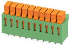
Leiterplattenklemme, Nennstrom: 5 A, Bemessungsspannung (III/2): 160 V, Nennquerschnitt: 0,34 mm<sup>2</sup>, Anzahl der Potenziale: 10, Anzahl der Reihen: 1, Polzahl pro Reihe: 10, Artikelfamilie: IDC 0,3, Rastermaß: 3,81 mm, Anschlussart: Schneidanschluss, Montage: Wellenlöten, Anschlussrichtung Leiter/Platine: 0 °, Farbe: grün, Pin-Layout: Lineares Pinning, Pinlänge [P]: 3,4 mm, Anzahl der Löt pins pro Potenzial: 1, Verpackungsart: verpackt im Karton
