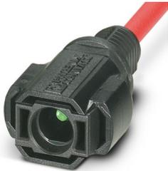
Gerätesteckverbinder Vorderwand, Artikelfamilie: SUNCLIX, Farbe: schwarz, Polzahl: 1, Aderquerschnitt min.: 2,5 mm<sup>2</sup>, Bemessungsspannung: 1000 V DC, Bemessungsstrom: 27 A, Anschlussart: Crimp, Kabellänge: 300
