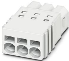
Leiterplattenstecker, Nennquerschnitt: 0,5 mm<sup>2</sup>, Farbe: weiß, Nennstrom: 6 A, Bemessungsspannung (III/2): 160 V, Kontaktoberfläche: Sn, Kontaktart: Buchse, Anzahl der Potenziale: 6, Anzahl der Reihen: 1, Polzahl: 6, Anzahl der Anschlüsse: 6, Artikelfamilie: PTSM 0,5/...-P WH, Rastermaß: 2,5 mm, Anschlussart: Push-in-Federanschluss, Anschlussrichtung Leiter/Platine: 0 °, Stecksystem: COMBICON PTSM, Verriegelung: ohne, Befestigungsart: ohne, Verpackungsart: verpackt im Karton
