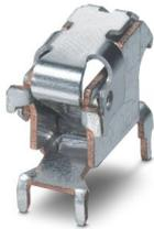
Leiterplattenklemme, Nennstrom: 41 A, Nennquerschnitt: 6 mm<sup>2</sup>, Anzahl der Potenziale: 1, Anzahl der Reihen: 1, Polzahl pro Reihe: 1, Artikelfamilie: PTSPL 6/..., Rastermaß: 0 mm, Anschlussart: Push-in-Federanschluss, Montage: THR-Löten / Wellenlöten, Anschlussrichtung Leiter/Platine: 0 °, Farbe: kupferfarben, Pin-Layout: Lineares Pinning, Pinlänge [P]: 2,9 mm, Anzahl der Lötpins pro Potenzial: 4, Verpackungsart: Gurt in 32 mm Breite
