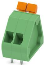
Leiterplattenklemme, Nennstrom: 12 A, Bemessungsspannung (III/2): 200 V, Nennquerschnitt: 1 mm<sup>2</sup>, Anzahl der Potenziale: 2, Anzahl der Reihen: 1, Polzahl pro Reihe: 2, Artikelfamilie: ZFKDS(A) 1-W, Rastermaß: 3,81 mm, Anschlussart: Zugfederanschluss, Montage: Wellenlöten, Anschlussrichtung Leiter/Platine: 45 °, Farbe: grün, Pin-Layout: Lineares Pinning, Pinlänge [P]: 3,5 mm, Anzahl der Lötpins pro Potenzial: 2, Verpackungsart: verpackt im Karton
