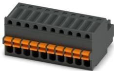
Leiterplattenstecker, Nennquerschnitt: 0,5 mm<sup>2</sup>, Farbe: schwarz, Nennstrom: 4 A, Bemessungsspannung (III/2): 160 V, Kontaktoberfläche: Sn, Kontaktart: Buchse, Anzahl der Potenziale: 10, Anzahl der Reihen: 1, Polzahl: 10, Anzahl der Anschlüsse: 10, Artikelfamilie: FK-MC 0,5/..-ST, Rastermaß: 2,5 mm, Anschlussart: Push-in-Federanschluss, Anschlussrichtung Leiter/Platine: 0 °, Stecksystem: COMBICON FK-MC 0,5, Verriegelung: ohne, Befestigungsart: ohne, Verpackungsart: verpackt im Karton
