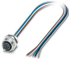
Gerätesteckverbinder Vorderwand, Universal, 5-polig, Buchse, gerade, M12-Standard, Kodierung: A, auf freies Leitungsende, Vorderwandmontage, Pg9, Einzellitzen, Kabellänge: 0,5 m, 0,34 mm<sup>2</sup>, TPE-Litze, vergossen
