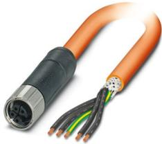
Powerleitung, 5-polig, PUR halogenfrei, orange RAL 2003, freies Leitungsende, auf Buchse gerade M12, Kodierung: K, Kabellänge: 15 m, für Wechselstrom bis 16 A/690 V
