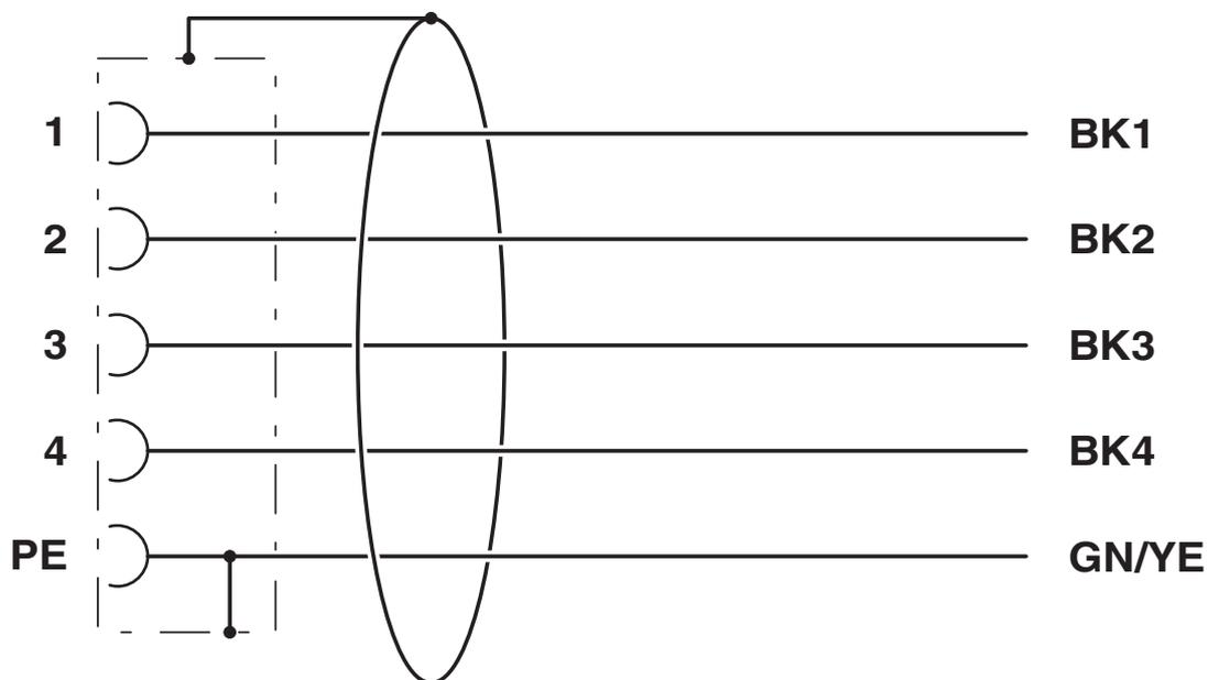
Kontaktbelegung der M12-Buchse
