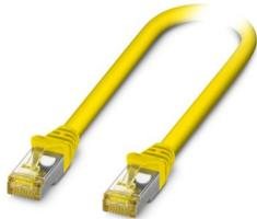
Patch-Kabel, Kabellänge: 7,5 m, Polzahl: 8, 10 GBit/s, CAT6<sub>A</sub>, Anschlussquerschnitt: AWG 26-26, Ethernet
