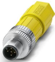
Steckverbinder, Universal, 5-polig, ungeschirmt, Stecker gerade M12, Kodierung: A, Push-Lock-Federanschluss, Rändelmaterial: Zinkdruckguss, vernickelt, Leitungsaußendurchmesser 4 mm .. 8 mm, Farbe: gelb (Tüllengehäuse und Druckmutter)
