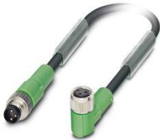
Sensor-/Aktor-Kabel, 3-polig, PUR halogenfrei, schwarzgrau RAL 7021, Stecker gerade M8, Kodierung: A, auf Buchse gewinkelt M8, Kabellänge: 1 m
