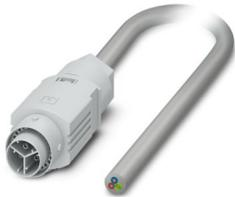
Verbindungsleitung, Anschlussart: Push-Lock-Anschluss, Polzahl: 2+PE, Stift, 450 V, 16 A, PA, lichtgrau, Kodierung: P, 2,5 mm<sup>2</sup>, Leitungslänge: 1,5 m, Stift gerade, auf freies Leitungsende
