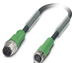
Sensor-/Aktor-Kabel, 4-polig, PUR halogenfrei, schwarzgrau RAL 7021, Stecker gerade M12, Kodierung: A, auf Buchse gerade M8, Kodierung: A, Kabellänge: 3 m
