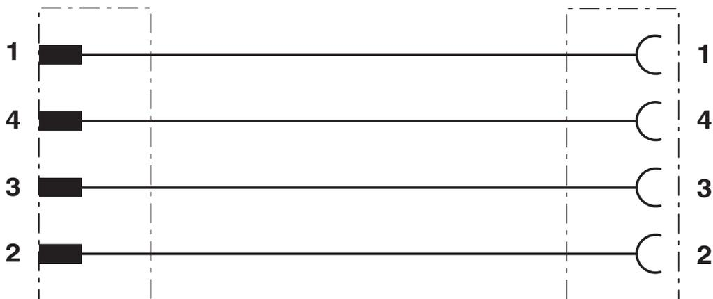
Kontaktbelegung der M12-Stecker / M8-Buchse
