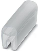
Ader-Bezeichnungsträger, transparent, unbeschriftet, Kabeldurchmesserbereich: 2 ... 4 mm, Montageart: aufschieben, Textfeldhöhe: 4 mm, Textfeldbreite: 18 mm
