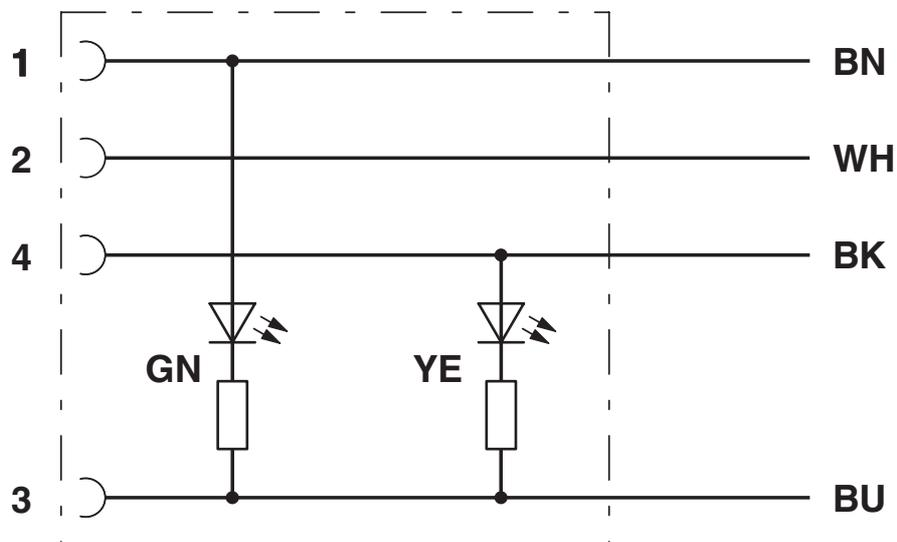
Kontaktbelegung der M12-Buchse mit LED
